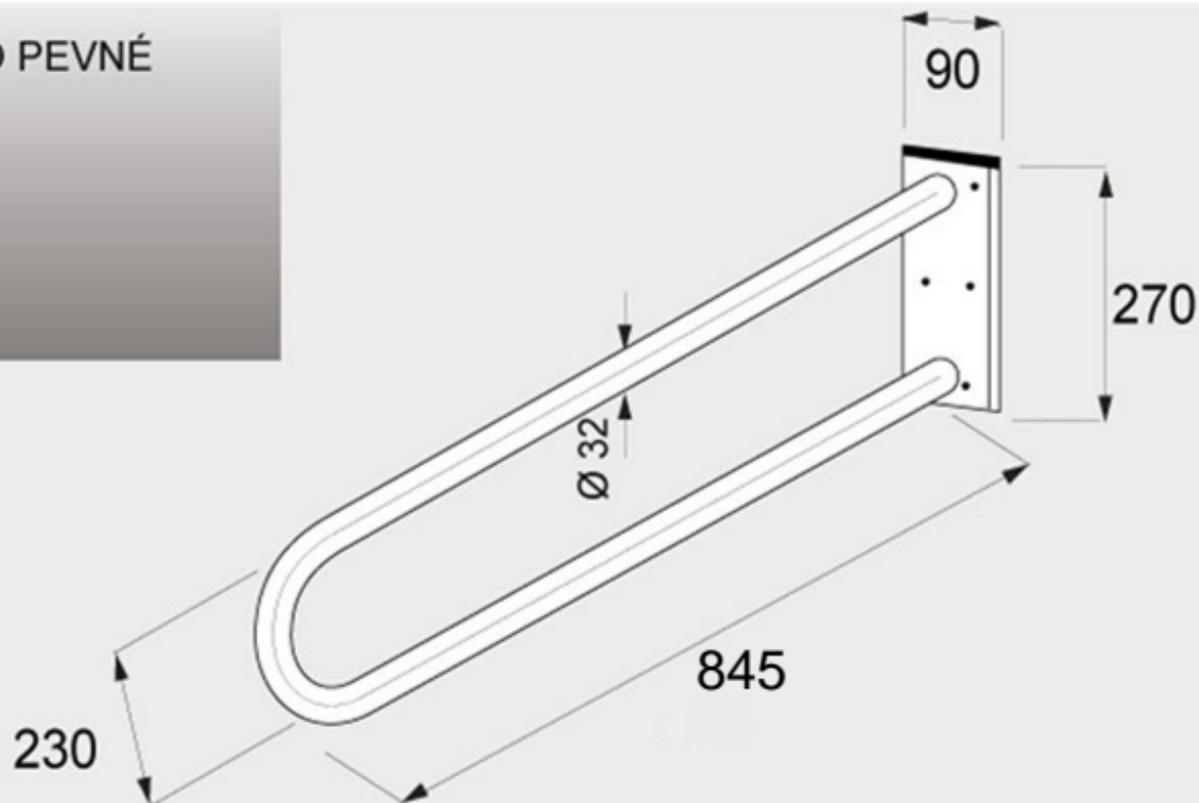
\*součástí madla je 6 ks hmoždének  $\varnothing 10$  do plného materiálu a 6 ks nerezových vrtů 5x60
